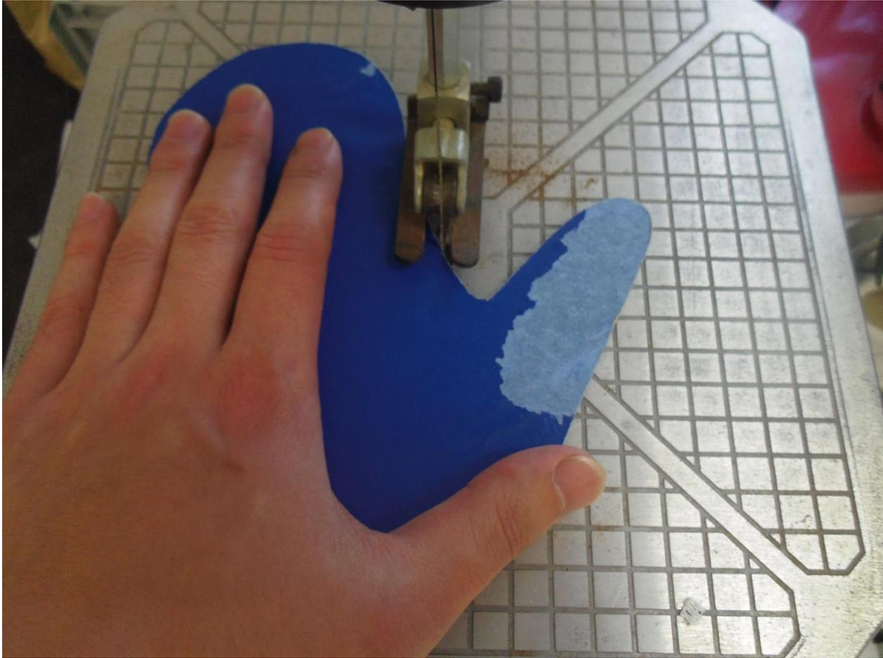
※ハサミでは切り取るのが大変なため、電動ノコギリを使用。
